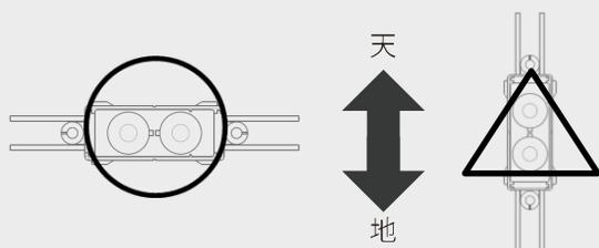
本製品を設置面に取り付けをする際は、設置方向にご注意ください。設置の際は、配線を伝って水滴がモジュールへかからないように、左図のように設置の際に配慮をお願いいたします。
