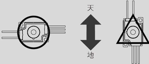
本製品を設置面に取り付けをする際は、設置方向にご注意ください。設置の際は、配線を伝って水滴がモジュールへかからないように、左図のように設置の際に配慮をお願いいたします。
